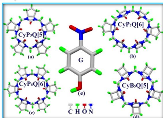
Сообщается о супрамолекулярной самосборке CyP<sub>5</sub>Q[5], CyP<sub>6</sub>Q[6], CyP<sub>2</sub>Q[6] и (CyB<sub>5</sub>Q[5]). В этих четырех системах ионы кальция были введены для координации с кукурбит[*n*]урилом, а *p*-нитрофенол был дополнен на внешнюю поверхность кукурбит[*n*]урила для построения четырех супрамолекулярных каркасов.
