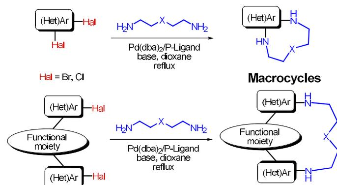
Продемонстрировано, что Pd(0)-катализируемое аминирование является универсальным подходом для синтеза *N*- и *O*-содержащих макроциклов и полимакроциклов. Реакции проходят с участием (гетеро)арил-дигалогенидов, линейных оксадиаминов, полиаминов, различных азакраун-эфиров.
